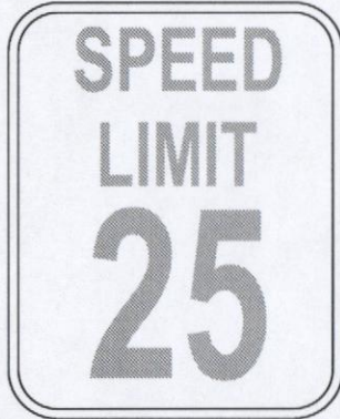
FDOT STANDARD R2-1 SPEED LIMIT SIGN 1'-5" x 2'-0" N.T.S.
