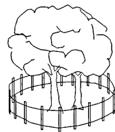
TREE BARRICADE DETAIL N.T.S.
